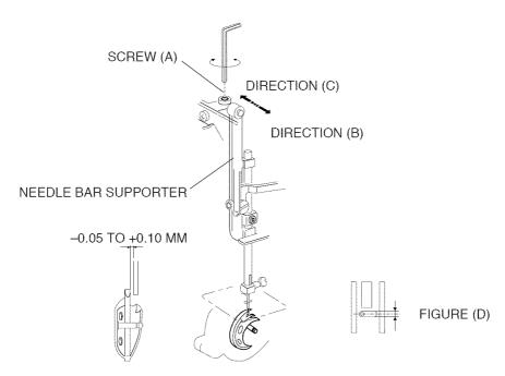
CLEARANCE BETWEEN NEEDLE AND NEEDLE PLATE SHOULD BE 0.15 MM OR MORE.
